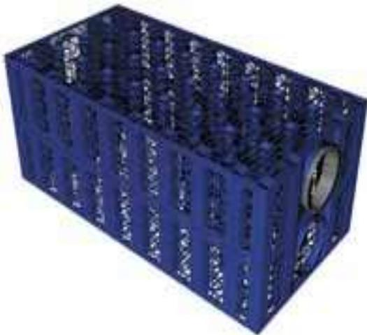
Der Sickerblock wird mit Geotextil ummantelt und in das Erdreich eingebracht. Die Blöcke mit einer Größe von 100 x 50 x 40 cm und einer Speicherleistung von 190 Litern lassen sich sehr variabel zusammenstellen für beliebig große Flächen, in Reihe oder Blockform, in einer oder mehreren Schichten. Die Einbaufläche kann also den örtlichen Gegebenheiten angepasst werden.
